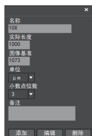
(4) 步骤四：在标定表内输入名称，如10X，在标定表内输入刚刚在测微尺上所绘的直线的实际长度，比如本示例图是绘制了100个DV，即1mm (或1000μm)，则在“实际长度”框内输入指定处填入1000“单位”选择μm。再点击“添加”，即可将此标定值添加到标定表内待用。按此方法为其他不同倍率的物镜添加标定值。
