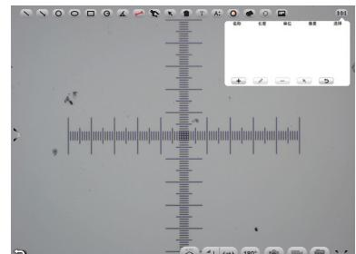
步骤四：输入名称、测微尺的实际长度，选择单位。当您在标尺上绘制后，像素值将自动输入，如图所示。单击“确定”完成标定；
