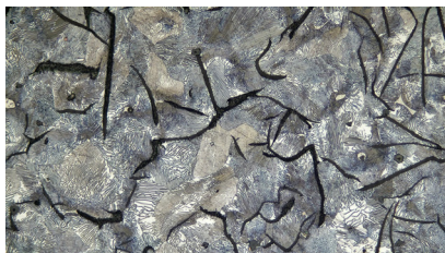
灰铸铁（物镜倍率：50X）
